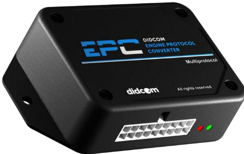
EPC es un dispositivo diseñado para la conversión de protocolos específicos de comunicación ya sea CANbus propietarios, CAN J1939 o Bus de comunicación J1708, éstos son convertidos a protocolo estándar SAE J1939, al mismo tiempo el dispositivo tiene la capacidad de filtrar datos de motor y códigos de falla, de igual forma puede calcular datos que no existen como tal en el bus, lo cual permite la obtención de distintos parámetros de gran importancia.
