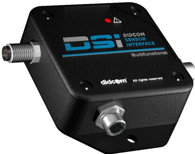
DSI es un dispositivo diseñado para la obtención de información del medio físico a través de componentes externos de tipo sensorial, la interface puede ser digital, analógica o de conexión directa, dichos dispositivos están clasificados cada uno por su tipo, es decir, cada dispositivo solo realiza una función a la vez.
